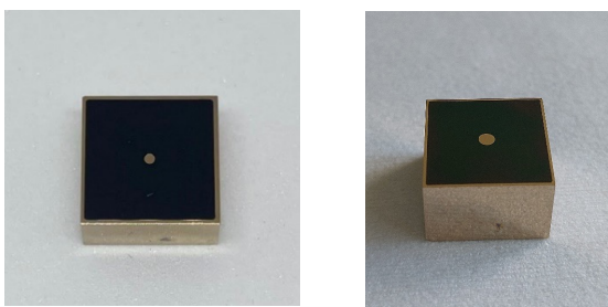
Detector emisferici, da sinistra 10 \times 10 \times 5 \text{ mm} , 15 \times 15 \times 10 \text{ mm}
